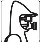
チップの目づまり、交換、接続の異常その他の補修は、必ずポンプを停止させたのちノズル本体のバルブを開き残圧を抜いて、ホースから外してから行ってください。なお、ポンプ作動中はノズルを放置しますと作業者以外の人が触ったり、又は機物等の接触によりバルブが開き薬液が噴霧する恐れがあり大変危険です。
