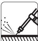
作業終了後はポンプを停止しても、ノズル及びホース内には使用中の薬液が残っています。必ずノズルの先端を前方下に向け、人や危険物がないか確認した後にポンプのバルブを開いて圧力を抜いてください。
