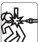
ポンプの作動時はノズル先端をしっかりと持ち、ポンプのバルブが閉まっているか確認し付近に人（特に子供）や動物がいないか、飛びだしの危険、又は危険物がないか、確認してください。
