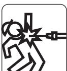
ポンプの作動時はノズル先端をしっかりと持ち、ポンプのバルブが閉まっているか確認し付近に人（特に子供）や動物がいないか、飛びだしの危険、又は危険物がないか、確認してください。
