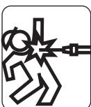
ポンプの作動時はノズル先端をしっかりと持ち、ポンプのバルブが閉まっているか確認し付近に人（特に子供）や動物がいないか、飛びだしの危険、又は危険物がないか、確認してください。
