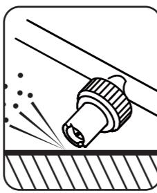
作業終了後はポンプを停止しても、ノズル及びホース内には使用中の薬液が残っています。必ずノズルの先端を前方下に向け、人や危険物がないか確認した後にポンプのバルブを開いて圧力を抜いてください。
