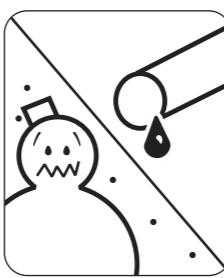
作業終了後ノズルを洗浄せずに長時間放置しておきますと薬剤が固着して、目つまり及び他の箇所の故障の原因になりますので十分注意してください。
