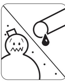
作業終了後ノズルを洗浄せずに長時間放置しておきますと薬剤が固着して、目つまり及び他の箇所の故障の原因になりますので十分注意してください。
