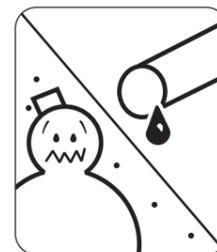
使用後はノズル本体内の水を抜くためホースから外してください。運搬保管に際しては下積にしたり、投げたり引きずったり他の目的には使用しないでください。寒冷地・冬季等では残水のまま放置しますと凍結破損をおこす恐れがありますので十分注意してください。なお、ノズルは子供の手の届かない屋内にて保管してください。
