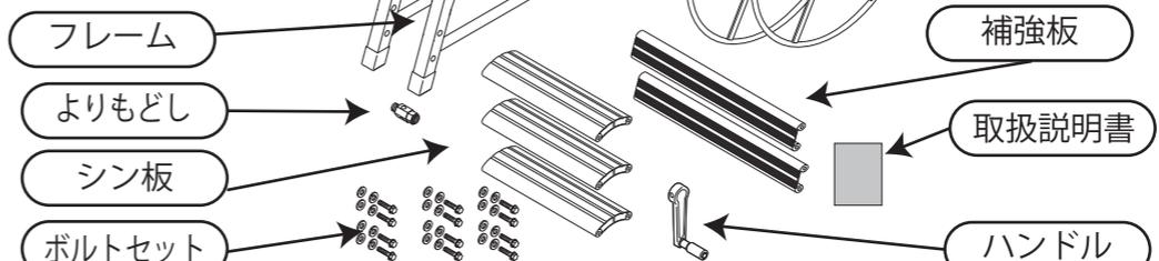
(M8x40 ボルト x12 個、M8x35 ボルト x8 個、M8 平ワッシャー x20 個、M8S ワッシャー x20 個、M8 ボルトナット付 x6 個)
