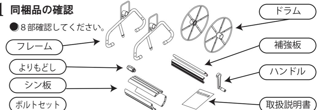
(M8x40 ボルトx12個、M8x45 ボルトx8個、M8 平ワッシャーx12個、M8S ワッシャーx12個、R座金x8個、M8 ボルトナット付x6個) 1
