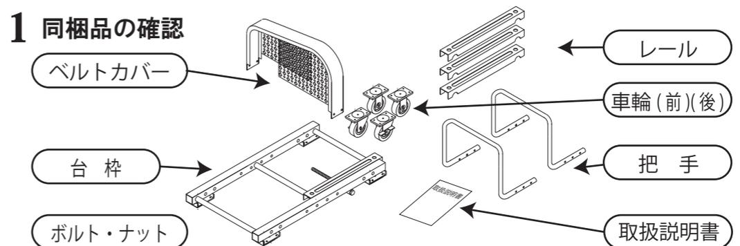
M8Uボルトx8個、M8フランジナットx16個、M8x40セムスボルトx8個、M6x40セムスボルトx4個、M5x15セムスボルトx16個、M8ワッシャーx8個、M8ナットx8個、M6ワッシャーx4個、M6ナットx4個、M6x12セムスボルトx4個
